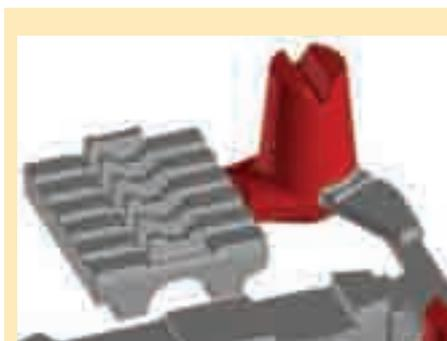
Рис. 1. Модель отливки с выделенными прибылями
